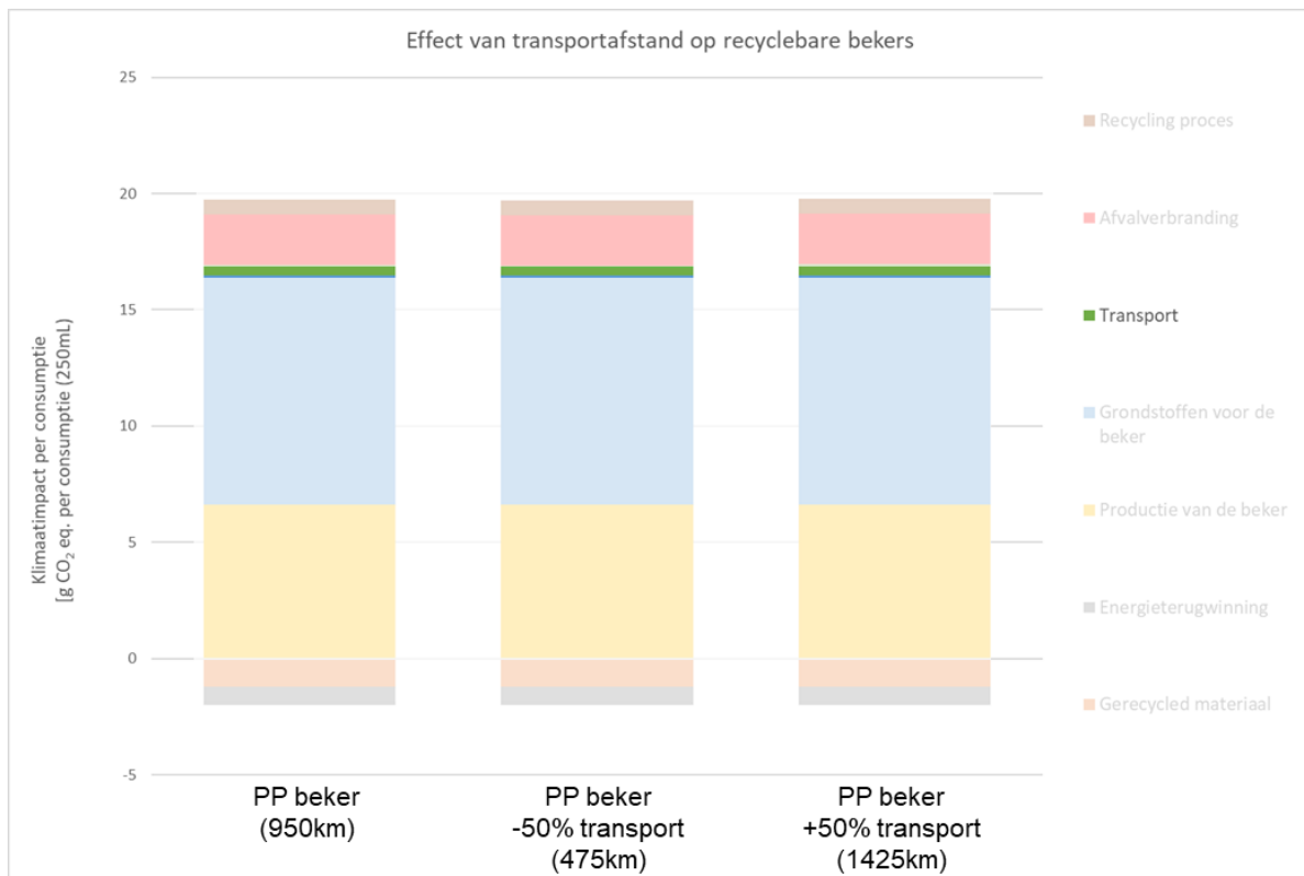
Figuur 12: Effect van transport van recycleerbare eenmalige beker van 4,5 gram, inclusief 90% inzameling voor recycling
